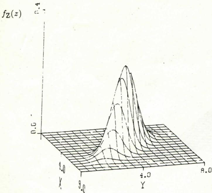
Abb. 3: Dichte der  $N\left(\begin{pmatrix} 4 \\ 4 \end{pmatrix}, \begin{pmatrix} 1 & -0,8 \\ -0,8 & 1 \end{pmatrix}\right)$ -Verteilung
